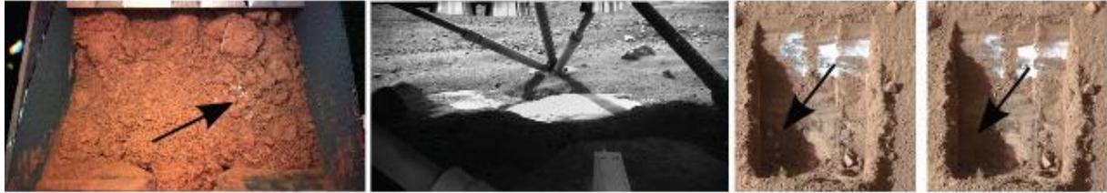
Abb. 6: (Links) Wahrscheinlich Wassereis in der Schaufel des Roboterarms, aufgenommen von der RAC-Kamera. (Mitte) Ein Blick unter den Lander, wo die Bremsraketen hartes, helles Material (Wassereis) freigeblasen haben ("Holy-Cow"-Struktur). (Rechts) Zwei Abbildungen zu verschiedenen Zeiten (Sol 20 und 24), die zeigen, wie das Wassereis schmilzt.
