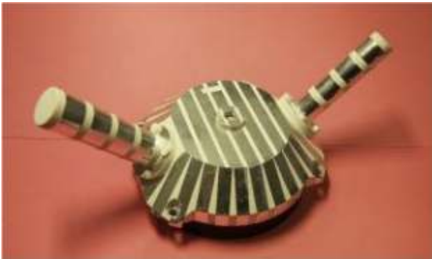
Abb. 6: Teilchenanalysator auf dem ersten deutschen Forschungssatelliten AZUR (1969). Dieses Gerät wurde am Institut entwickelt und gebaut und begründete die lange Erfahrung auf dem Gebiet der Magnetosphärenmessungen.
