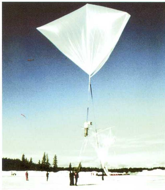
Abb. 3 Aufstieg eines Stratosphärenballons (hinten) in Kiruna/Schweden. Im Vordergrund ist der Hilfsballon zu sehen, an dem der Kryosammler hängt.
