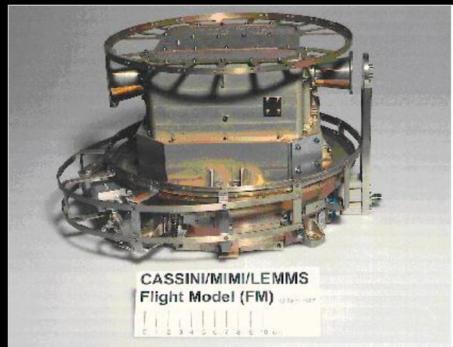
Das Teilchen-Spektrometer LEMMS (Low Energy Magnetospheric Measurement System) untersucht Energiespektren und räumliche Verteilungen von Ionen und Elektronen in der Magnetosphäre von Saturn.
