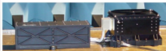
Das Wide-Band-Spektrometer. Links ist der optische Teil zu sehen. Dieser enthält zwei Laser, die Bragg-Zelle und das CCD. Rechts ist der elektronische Teil zu sehen. Dieser beinhaltet die Steuerungselektronik, die Analog-Digital-Wandler, die Spannungsversorgung und die Zwischenfrequenz-Einheit.
