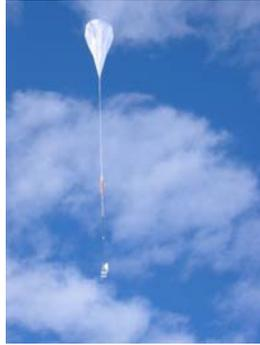
Die Atmosphäre ist undurchlässig für den Großteil der ultravioletten Strahlung, die für den Menschen zwar gefährliche, für die Sonnenforschung aber wichtig ist. In einer Flughöhe von 40 km wird ein großer Teil der UV-Strahlung für die *SUNRISE*-Instrumente messbar.
