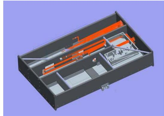
Das Innere der Instrumentenplattform mit dem Strahlengang für zwei Instrumente.
