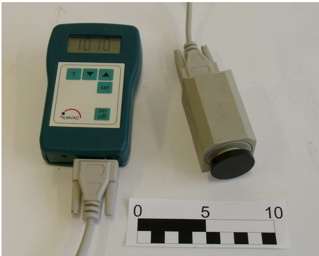
Abbildung 5.11: Der verwendete Pirani-Drucksensor inklusive des angeschlossenen Anzeigergerätes.
