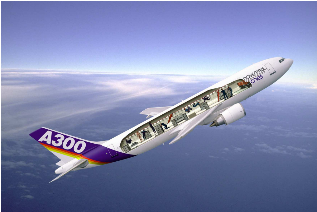
Abbildung 3.3: Parabelflugzeug der französischen Firma Novespace, die Parabelflüge für die ESA durchführt. Es handelt sich um ein herkömmliches Verkehrsflugzeug des Typs Airbus A300, das durch Modifikationen im Innenbereich angepaßt wurde: Die Schnittzeichnung verdeutlicht, daß das Innere des Flugzeuges im Mittelbereich von der Bestuhlung befreit wurde, um Platz für die eingebauten Experimente zu schaffen.
