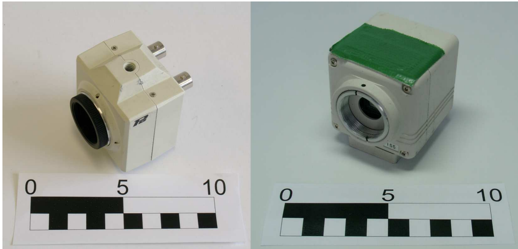
Abbildung 5.8: CCD-Kameras: das linke Bild zeigt die während des ADAM+EVE-Experiments genutzte CCD-Kamera, die aufgrund ihrer schlechten Bildqualität im CAIN+ABEL-Experiment durch das Modell auf der rechten Seite ersetzt wurde.
