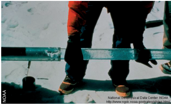
Abb. 2 Durch Bohrungen gewonnene Eiskerne (links), deren Schichtstruktur (rechts) in eine Zeitreihe übersetzt werden kann, werden auf ihren Gehalt an kosmogenen Isotopen unter-
