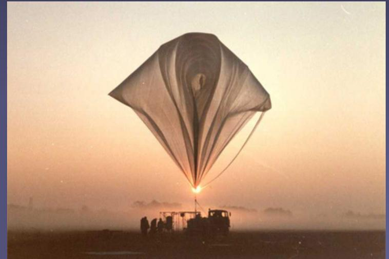
Ballongetragenes Observatorium mit einem 1-Meter Teleskop um Magnetkonvektion mit einer Auflösung von 35 km auf der Sonne zu studieren. Erster Ballonflug für 2009 geplant.
